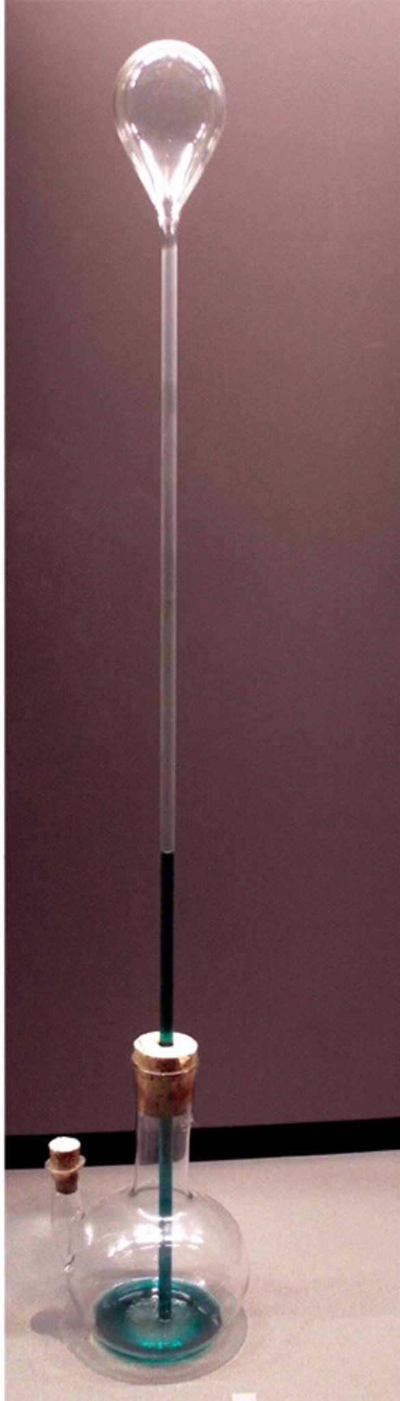
Termoscopio inventado por Galileo Galilei.
