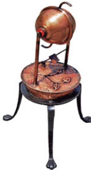
Eolipila. Dispositivo que genera movimiento con la fuerza del vapor.
