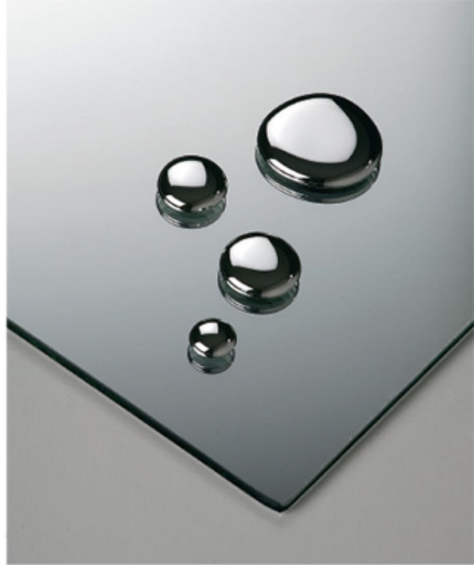
Metal en estado líquido. El mercurio se dilata y expande con el calor, por eso se usa en algunos termómetros.
