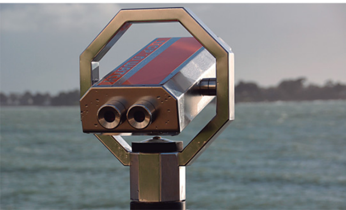
Los binoculares tienen lentes que amplían la imagen de los objetos distantes.
