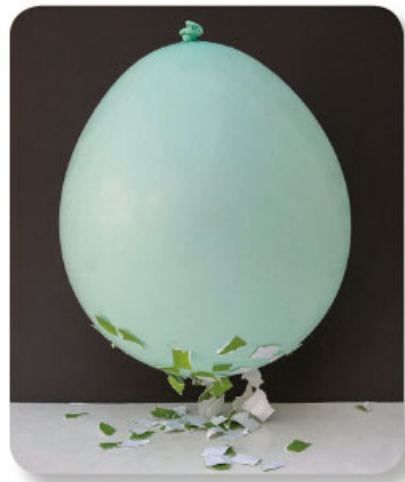
Figura 1.11 La fuerza de atracción electrostática vence a la fuerza de gravedad y los papelitos se levantan.
