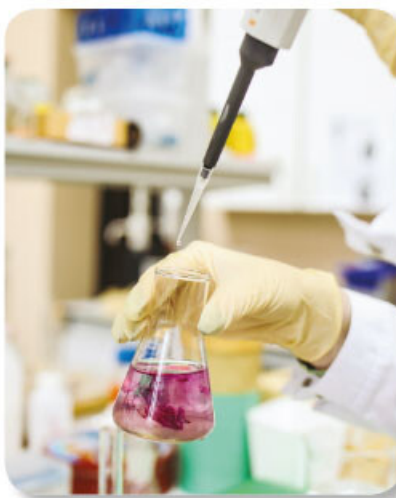
Figura 1.45 Al agregar una disolución de fenolftaleína a una disolución de una base, la primera se transforma en otra sustancia de color rosa, lo que confirma la presencia de la base.
