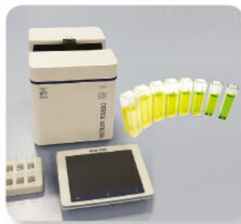
Figura 2.17 Los espectrofotómetros miden la cantidad de luz, de determinado color, que absorbe una disolución, con base en lo cual se puede calcular su concentración.
