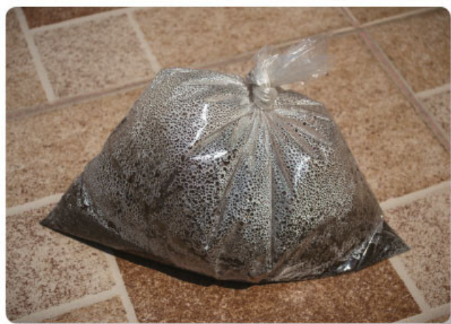
Figura 1.38 Si se deja al sol, el lodo permanece más tiempo húmedo dentro de una bolsa de ella, esto es evidente debido a las gotitas de agua que se forman dentro del plástico.
