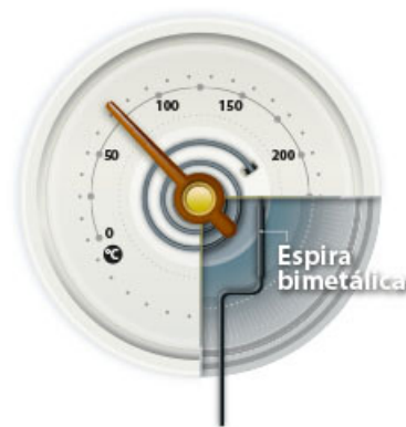
Figura 1.14 Un ejemplo de aplicación de la dilatación térmica es un termómetro de horno.
