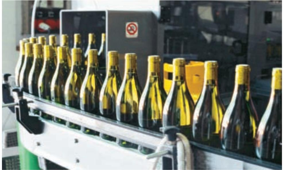
**Figura 5.3.** En los procesos industriales hay operaciones que realizan exclusivamente las máquinas. Por ejemplo, en esta envasadora, el manejo y el desplazamiento de los envases son automáticos y el operador se limita a minimizar errores o a corregir anomalías.
