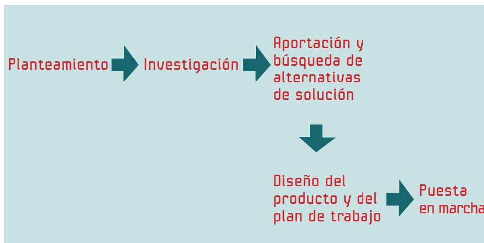
Figura 5.1. Secuencia de fases de un proyecto técnico.
