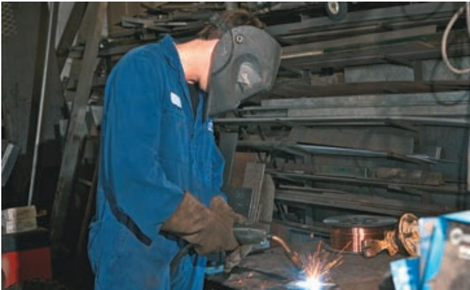
**Figura 3.16.** El riesgo de que una chispa o un residuo metálico golpee el rostro o se introduzca en los ojos de este soldador se reduce al máximo con el uso de mascarillas protectoras. En general, los accidentes se reducen al adoptar medidas precautorias.
